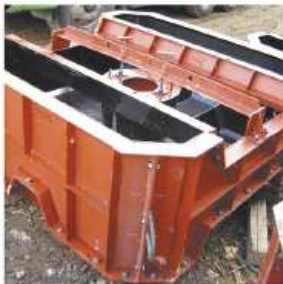
①型枠組立
