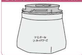
6 受枠高さの微調整とモルタル充填
