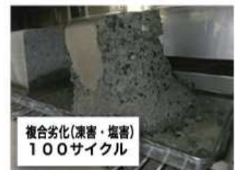
普通コンクリート
